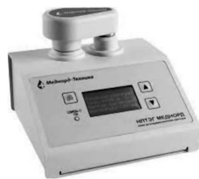
Рис. 2. Низкочастотный пьезотромбоэластограф «МЕДНОРД»
